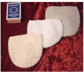
Zur Befestigung am Brenner ist dünner Draht (0,2-0,3 mm) aus Eisen oder rostfreiem Stahl geeignet (Kein Kupferdraht, schmilzt). Wegen der Dicke der Strümpfe ist die Befestigung kritisch; hier sollte mit Überlegung und Sorgfalt vorgegangen werden, damit einem beim Abflammen der Strumpf nicht vom Brennerwulst abrutscht.
