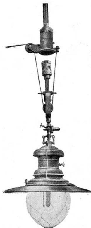
Fig. 28. Persgaslamp met koppeling voor het omlaaglaten.
